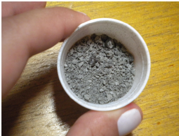
Figura 4 : Amostra pronta para análise. Após todas as etapas, inclusive o forno.
