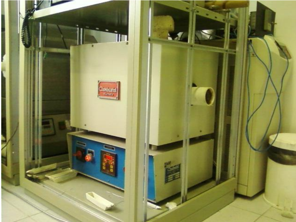
Figura 3: Vista lateral do forno com o cilindro cerâmico à direita
